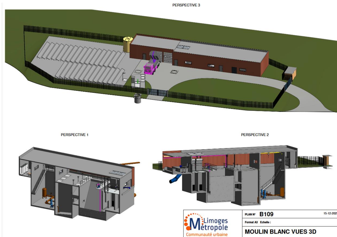
Figure 61 : Vue 3D du futur poste de refoulement de Moulin Blanc et du bassin d'orage associé
