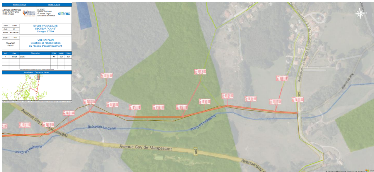
Figure 66 : Proposition de travaux - Réhabilitation du réseau d'assainissement - Secteur La Mazelle
