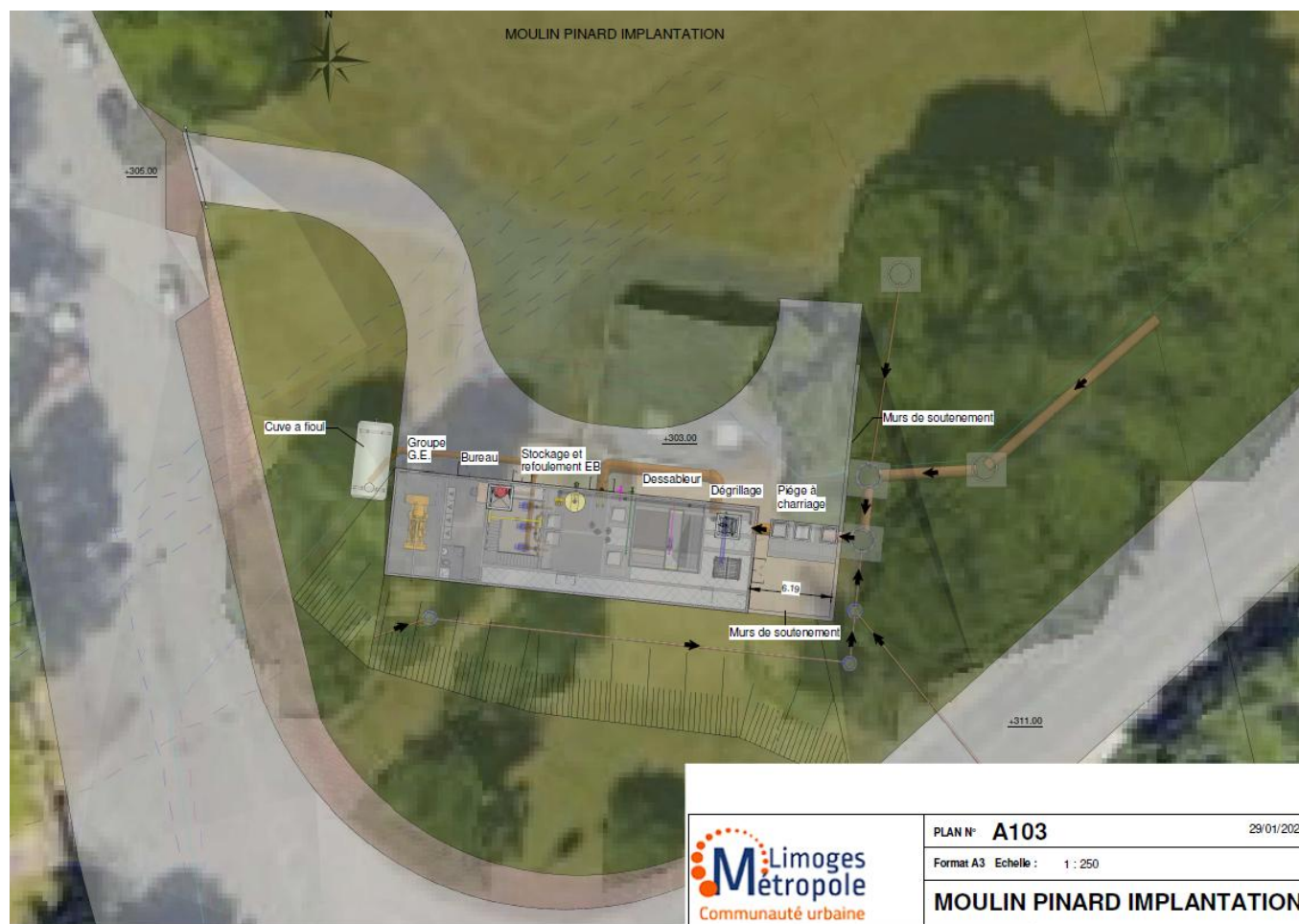
Figure 67 : Projet d'implantation du futur poste de refoulement de Moulin Pinard
